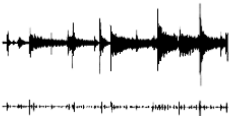
図-3 聴覚特性を考慮して、波形予測を行なった再合成波形と残差
