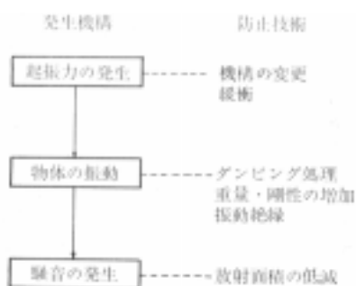
図3 物体の振動による騒音発生機構と適用される防止技術
