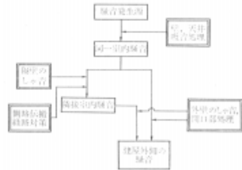
図18 建築的方法による伝搬経路対策の流れ
