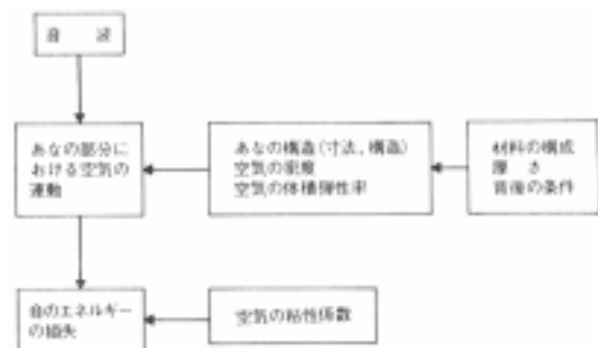
図1 多孔質材料の吸音機構
