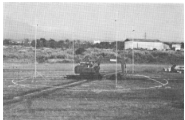
写真 土工機械の作業時騒音測定風景(建設機械化研究所)
