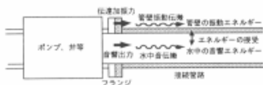
図2 ポンプ等振動・音の管路系における伝播模式図
