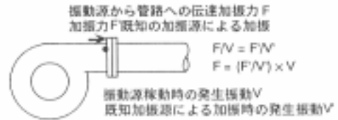
図14 音・振動源から管路への伝達加振力の測定概念図
